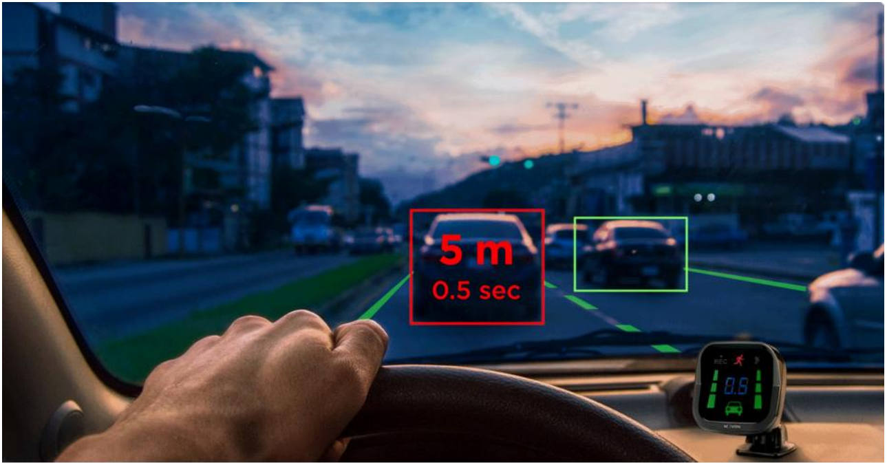
Figura 4 Exemplo de um sistema ADAS em um carro
